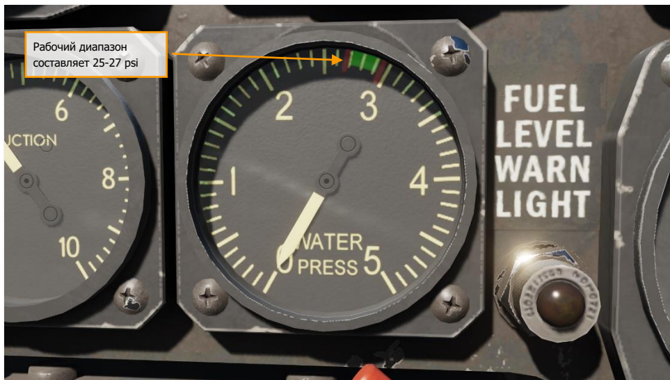
Рисунок 102. Нормальное давление в системе впрыска водно-метаноловой смеси составляет 25-27PSI
