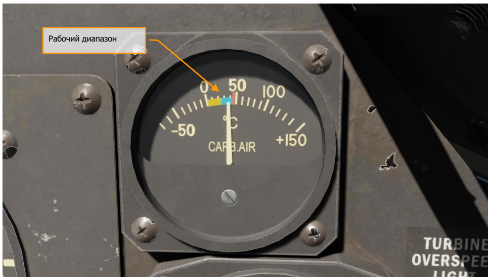
Рисунок 100. Рекомендуемый диапазон температуры воздуха, поступающего в карбюратор, составляет 0...40°C, предельное значение составляет +50°C
