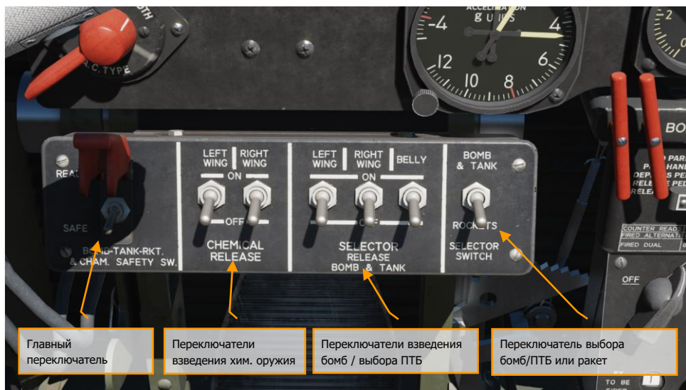
Рисунок 82. Панель управления вооружением/ПТБ
