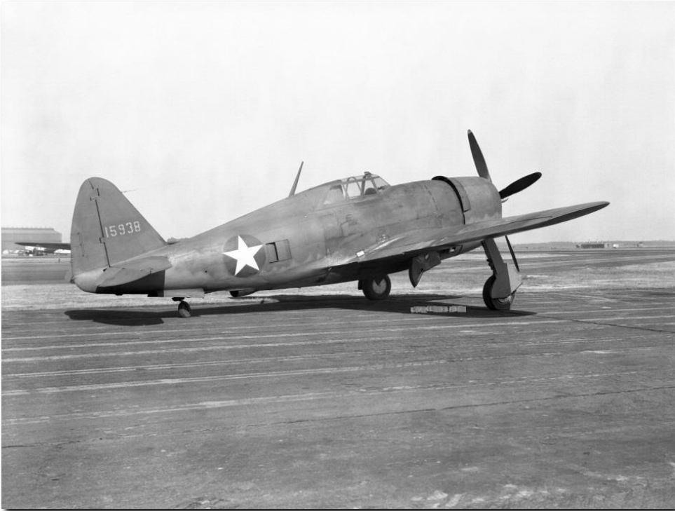
XP-47F – единственный экспериментальный вариант, переделанный (в 1943 г.) из варианта P-47B; с крылом ламинарного профиля.
