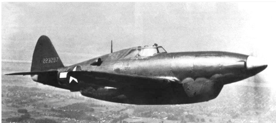
XP-47H – новое обозначение двух самолетов P-47D, использовавшихся в качестве испытательных стенов для перевернутого V-образного двигателя Chrysler XIV-2220-1 мощностью 2300 л.с.
