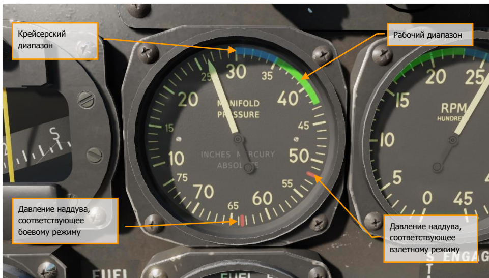
Рисунок 96. Шкала указателя давления наддува
