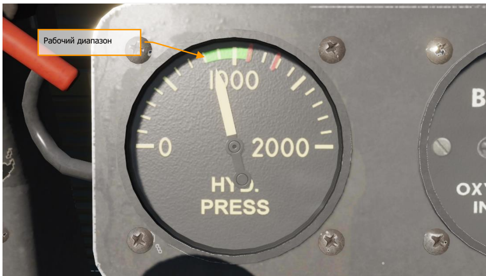
Рисунок 103. Нормальное рабочее давление в гидросистеме составляет 800-1100 psi. Максимально допустимое давление в гидросистеме составляет 1300 psi
